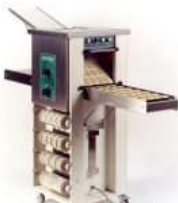
Машина оснащена длинным подающим лотком для теста. Подающий лоток может устанавливаться в два наклонных положения:
